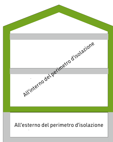
[FIG. 7] Definizione del perimetro d'isolazione.
